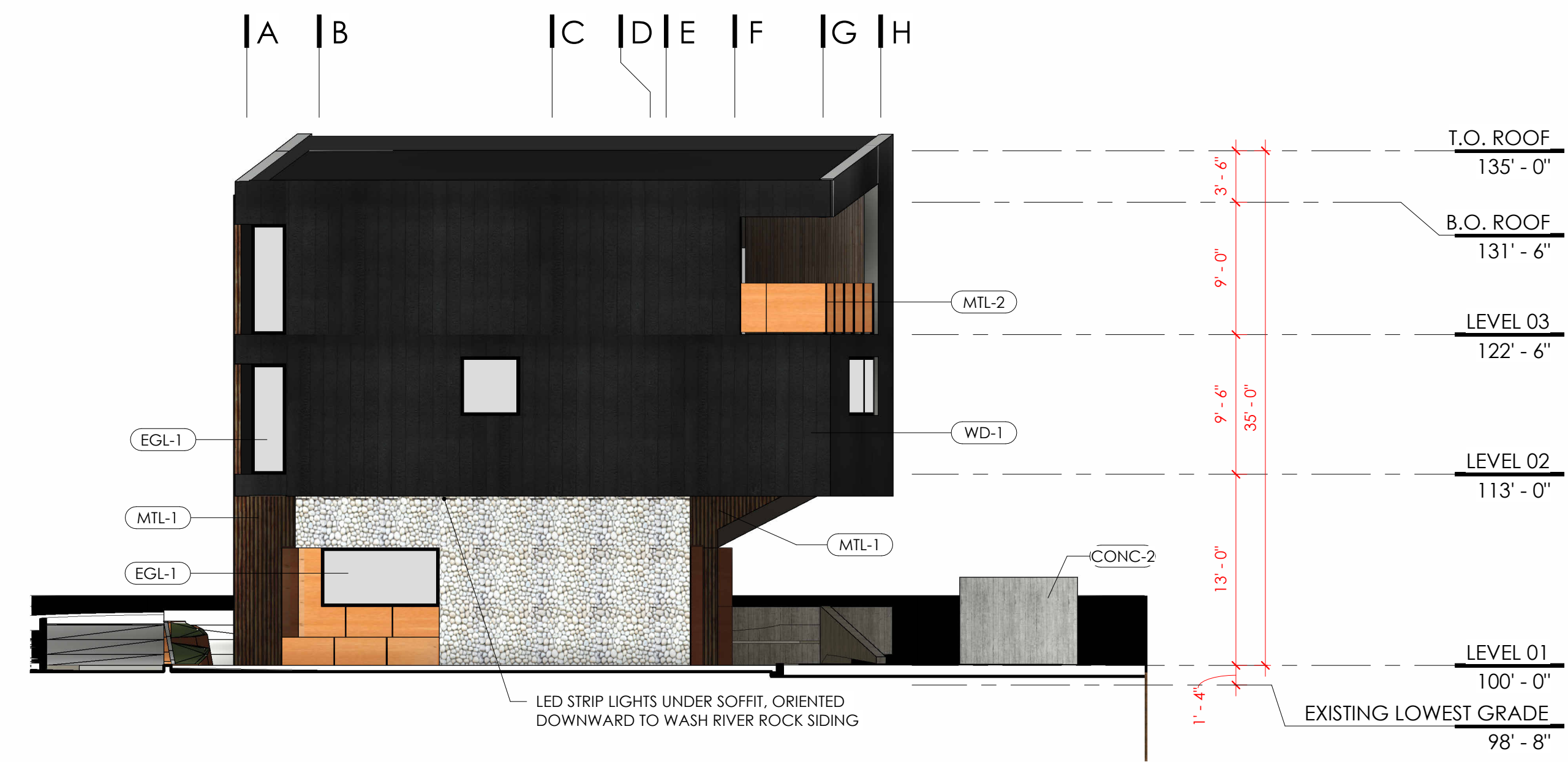
3 EXTERIOR ELEVATION - WEST A2.01 SCALE: 1/8" = 1'-0"
